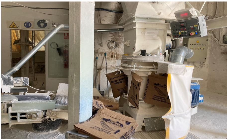
Figura 5. Ensacadora de “Blanco de España” de Blancos y Carbonatos Rodenses SL.
