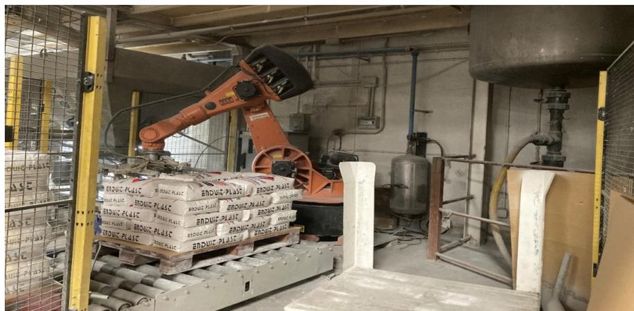
Figura 6. Robot paletizador de pintura al temple (Pinturas Adoral S.L.).
