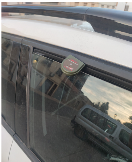
Figura 5. Micrófono del detector de ultrasonidos, asomando al exterior a través de la ventanilla del copiloto. Autor: Ángel Guardiola.
