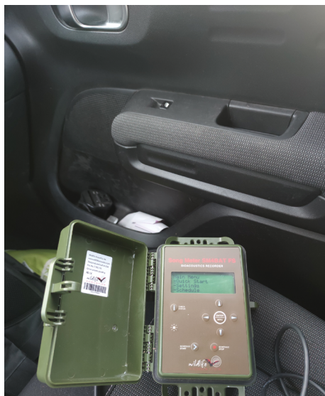
Figura 4. Detector de ultrasonidos SM4BAT-FS de Wildlife Acoustics. Autor: Ángel Guardiola.
