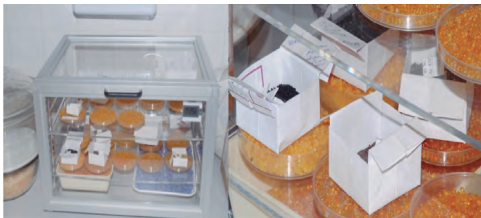
Figura 3. Cámara de desecación hermética donde se depositaron las muestras en cajas de papel, para permitir el trasiego de humedad entre las semillas y el gel de sílice colocado sobre placas Petri bajo las muestras.
